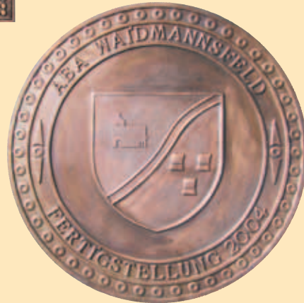
Schachtabdeckung mit Einbauring Art. 19615: Deckel ø 500 mm, Ring ø 590 mm, H: 80 mm, Deckel 26 kg, Ring 36 kg: Bronzeguss Art. 19620: Deckel ø 600 mm, Ring ø 720 mm, H: 130 mm, Deckel 85 kg, Ring 60 kg Sichtseite Bronzeguss, Unterseite Grauguss Art. 19616: Deckel ø 500 mm, Rahmen 675 x 675 mm, H: 90 mm, Deckel 26 kg, Rahmen 60 kg, Deckel und Rahmen aus Bronzeguss, begehbar und Pkw befahrbar, ohne Prüfzeichen
