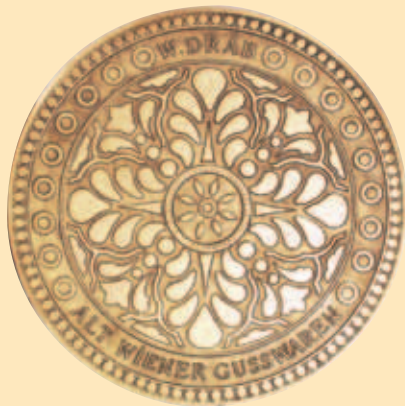
Schachtabdeckung mit Einbauring Art. 19615: Deckel ø 500 mm, Ring ø 590 mm, H: 80 mm, Deckel 26 kg, Ring 36 kg: Bronzeguss Art. 19620: Deckel ø 600 mm, Ring ø 720 mm, H: 130 mm, Deckel 85 kg, Ring 60 kg Sichtseite Bronzeguss, Unterseite Grauguss Art. 19616: Deckel ø 500 mm, Rahmen 675 x 675 mm, H: 90 mm, Deckel 26 kg, Rahmen 60 kg, Deckel und Rahmen aus Bronzeguss, begehbar und Pkw befahrbar, ohne Prüfzeichen
